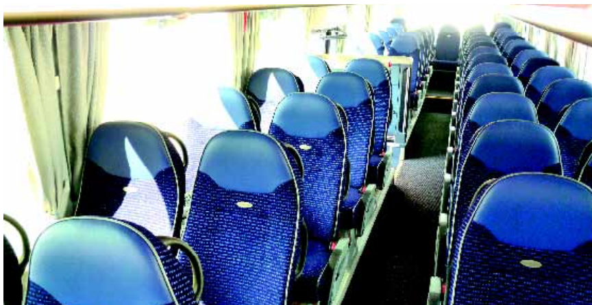
Typisch Neoplan: der blaue Fahrgastsalon, von MAN die Handläufe mit integrierter Innenbeleuchtung
