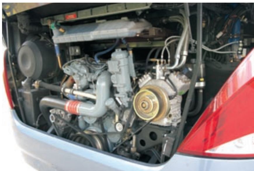
Löwenherz im Heck: mit 480 PS und maximal 2.300 Nm ist der Starliner standesgemäß unterwegs.
