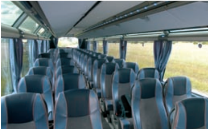
Viel Licht und Raum: Zu Gunsten der Dachrand-Verglasung verzichtet Neoplan auf die seitlichen Dachkanäle.
