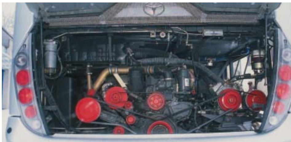
Economy beim Antrieb: Für das Fahrgestell liefert Mercedes nur den maximal 422 PS starken Reihensechszylinder OM 457 LA.
