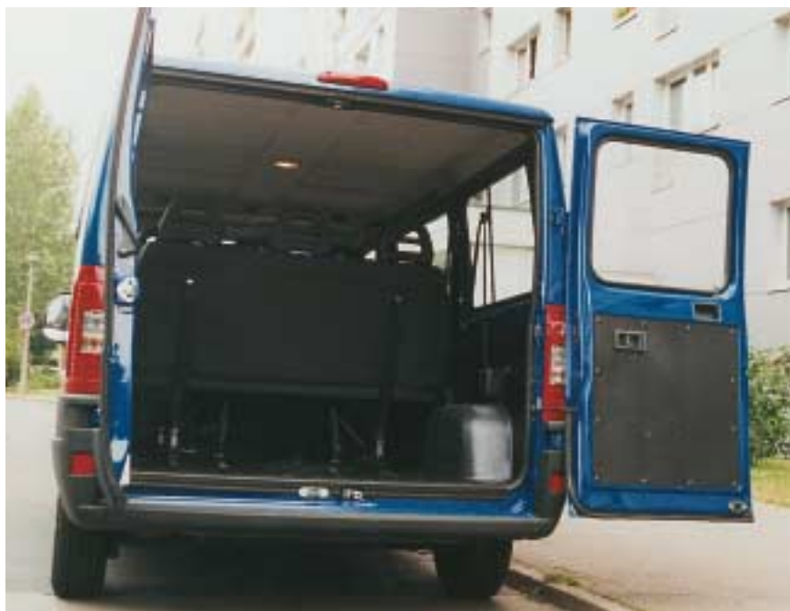
Die Hecktüren schwenken bis zu 180 Grad auf, rasten aber nur bei 90 Grad ein.
