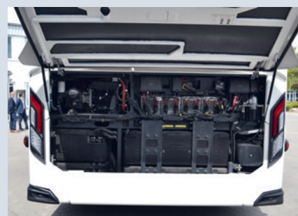
Blick auf wassergekühlte Aludruck-Batteriegehäuse
