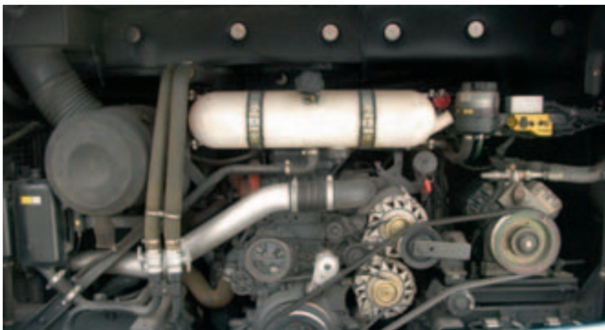
PB-Power: Turbocompound-Reihensechszylinder mit 480 PS und 2.250 Nm Drehmomentmaximum
