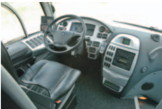
Cockpit mit Licht und Schatten – perfekte Pedalerie und Lenkung, unübersichtliches Schalter-Panel ohne Ordnung, kaum Ablagen
