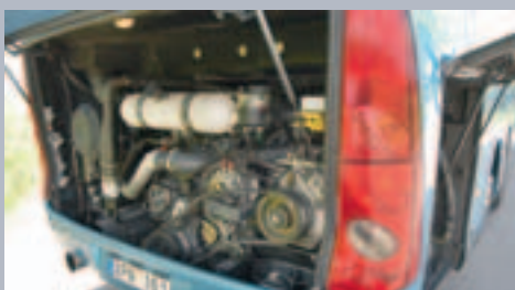
Power-Sixpack im Heck – der Turbocompound-Sechszylinder schiebt an wie ein großer V8.
