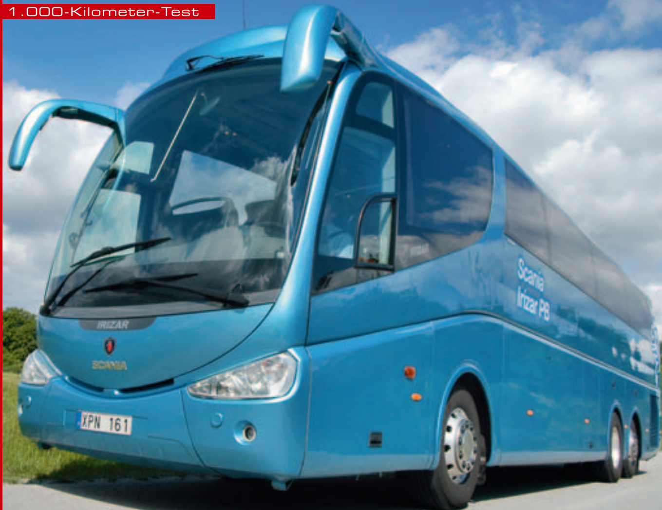
Zweifellos eine Ausnahmeerscheinung im Reisebusiness – der Superhochdecker Scania Irizar PB 1237 PB mit 13 Metern Länge
