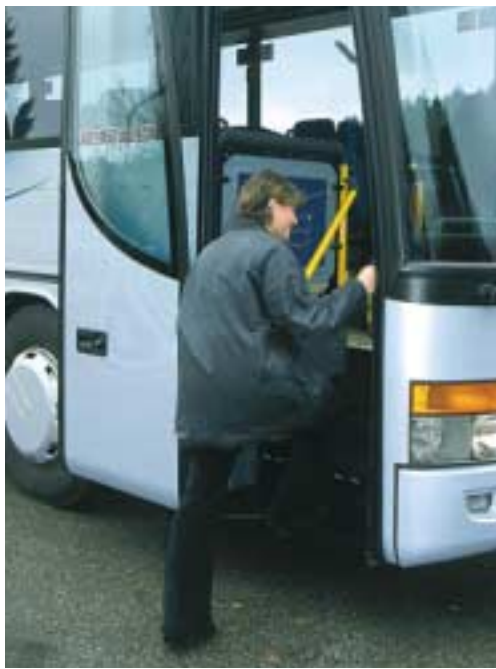
(von links oben nach links unten) Der vordere Einstieg: Niedrige Stufen und griffgünstige Handläufe zum Festhalten. Breiter und bequemer Ausstieg durch die Doppeltür; der Innenboden liegt auf bezuschungsfähigen 860 mm Höhe. Pflegeleicht und komfortabel: die Linienbestuhlung in Jeans-Look – hohe Lehnen und Sicherheitsgurte für Tempo 100-Zulassung
