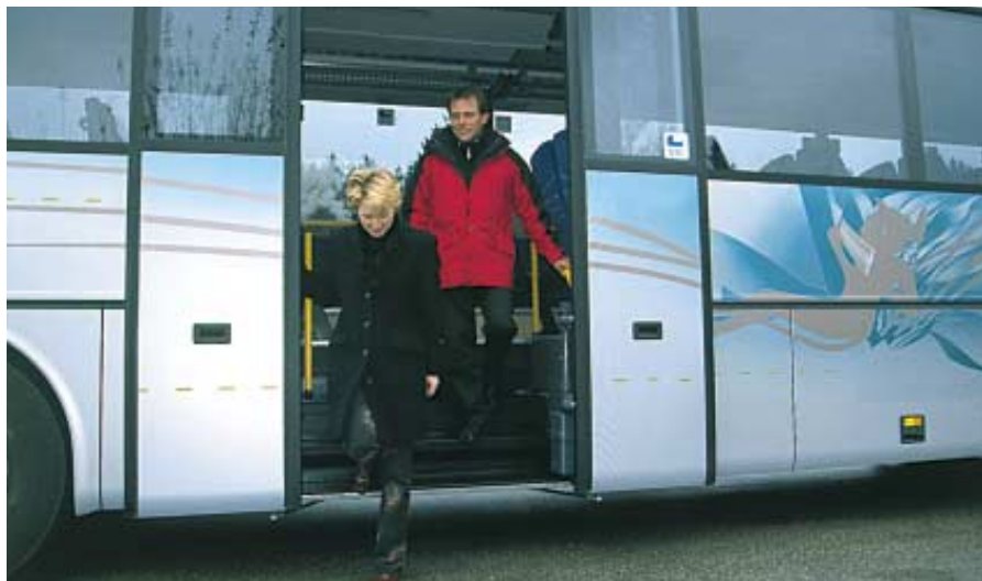
(von links oben nach links unten) Der vordere Einstieg: Niedrige Stufen und griffgünstige Handläufe zum Festhalten. Breiter und bequemer Ausstieg durch die Doppeltür; der Innenboden liegt auf bezuschungsfähigen 860 mm Höhe. Pflegeleicht und komfortabel: die Linienbestuhlung in Jeans-Look – hohe Lehnen und Sicherheitsgurte für Tempo 100-Zulassung
