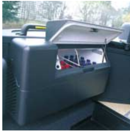
Charme von gestern: Der Armatureträger des S 316 UL – mit vie- len Analoguhren, Kon- trollleuchten und Schaltern ( links ) Für den Einsatz im Gelegenheitsverkehr: großer Kühlschrank für Bordgetränke als Anbaulösung für den Bugschrank ( rechts )
