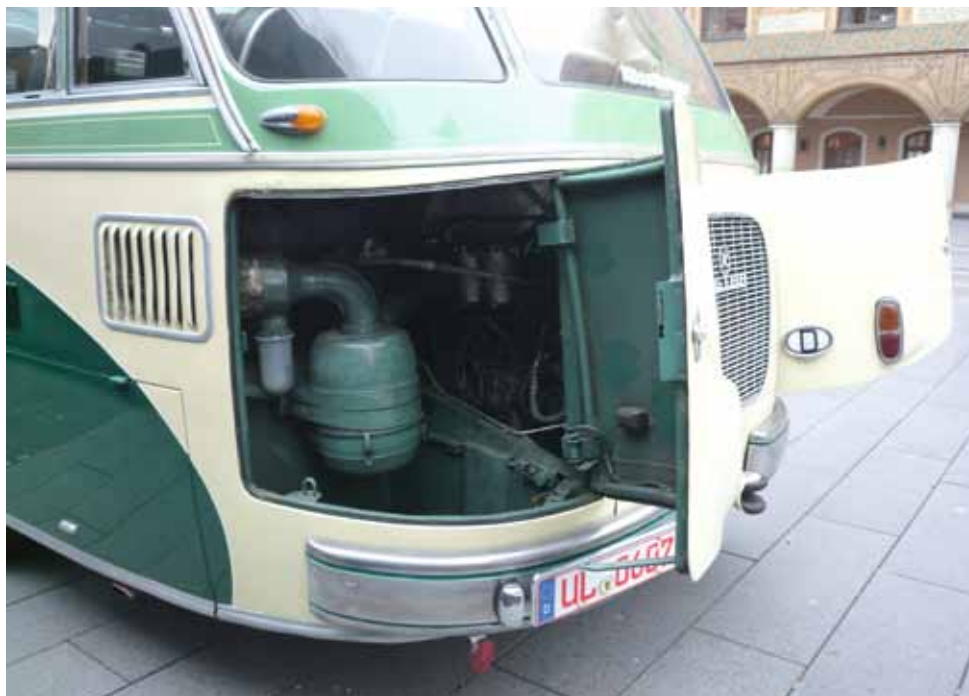
Oben: Be- und Entlüftung übers Aufstellfenster, darunter: bescheidener Kofferraum im Untergeschoss. Großes Bild: Der große Luftfilter steht vor der Maschine.
