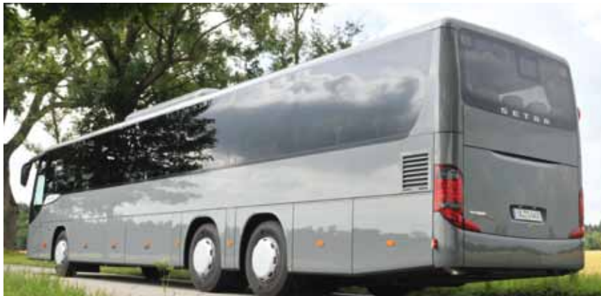
Das lange Heck schert aus: Die lenkbare Nachlaufachse verlängert in engen Radien den Überhang.
