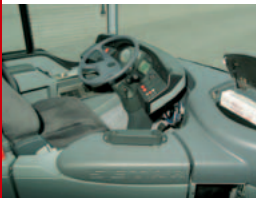
Das VDV-Cockpit mit K im Lenkrad – der neue Standard im Setra NF
