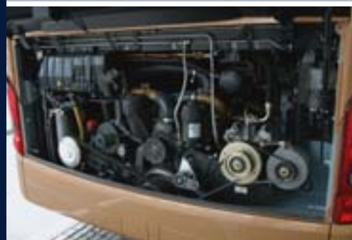
Bestbesetzung im Heck: antrittsstarker Sechszylinder OM 457 LA mit 428 PS und 2.100 Nm
