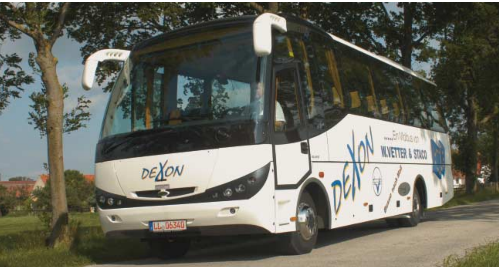
Technik aus Deutschland in spanischem Kleid – der Dexon S1 von Staco rollt auf dem Frontmotor-Fahrgestell 10.225 FOCL von MAN.
