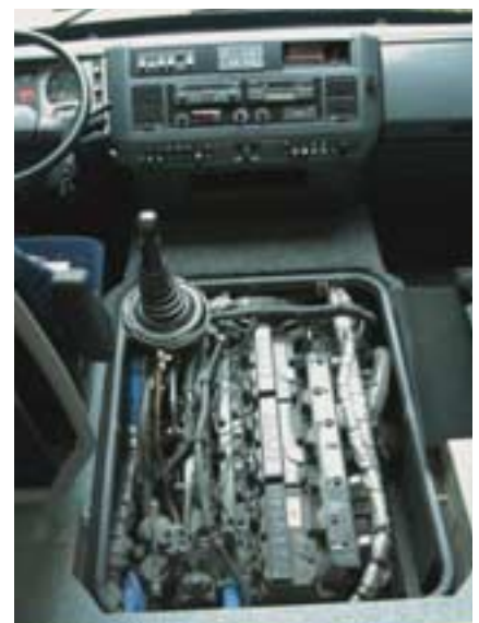
Der kräftige Sechszylinder sitzt auf der Vorderachse – der schwere Revisionsdeckel muss nur in der Werkstatt abgenommen werden.
