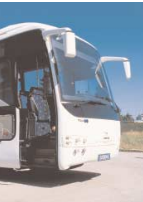
Im Mitteleinstieg 1.250 mm Breite und 340 mm Einstiegshöhe, signalgelber Antirutschbelag auf den Stufen
