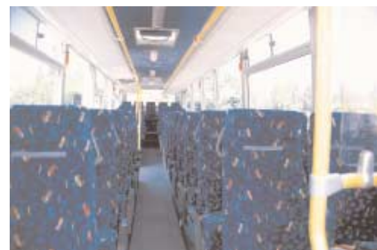
Wenig spektakulär ist der Innenraum mit hoch/festen Sitzen – das Zirpen der Haltestangen und Gepäckablagen verrät Vibrationen, die auf die Karosseriestruktur übertragen werden.
