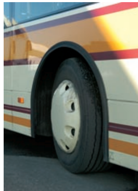
Das Heck lenkt mit, die Achse wird vom Drehgelenk über Schubstangen angesteuert.
