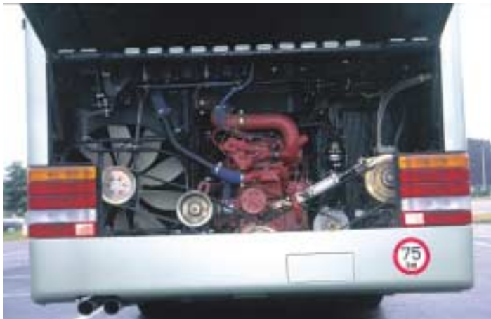
Sorgt für mächtig Dampf: der MAN-Reihensechszylinder mit 460 PS
