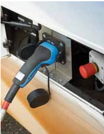
Statt zu tanken wird hier per Stecker geladen. Der rote Notfallknopf entlädt die Hochvoltanlage.
