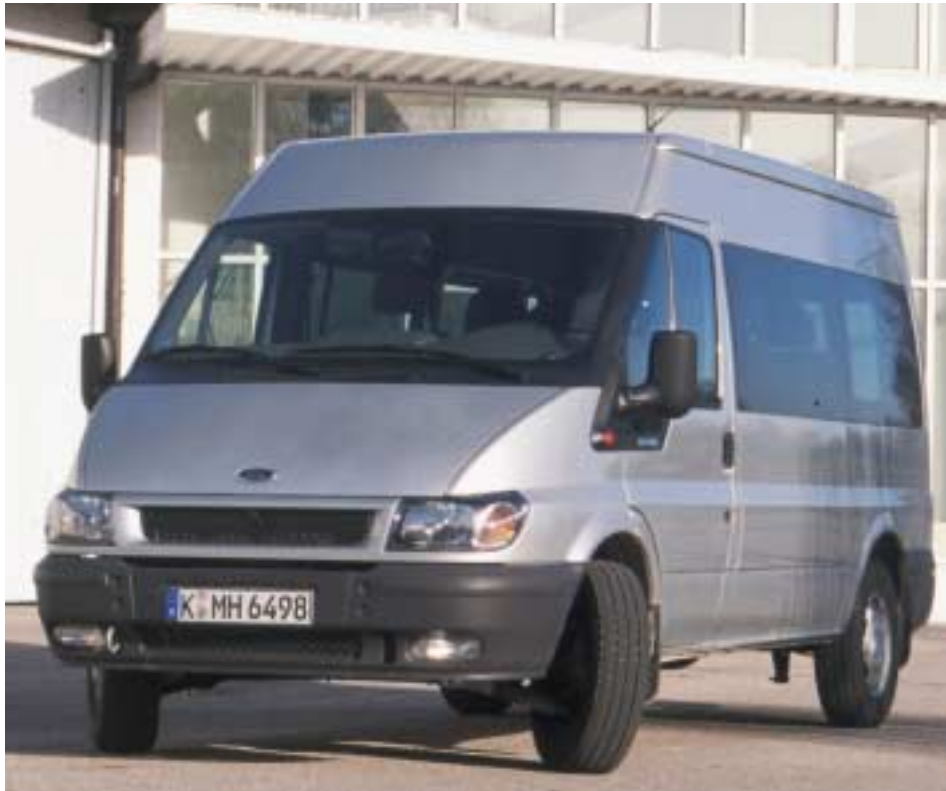
Mittelhohes Dach, bündig verklebte Seitenscheiben, glatte, waschstraßenfreundliche Seitenflächen: der Ford Transit Durashift
