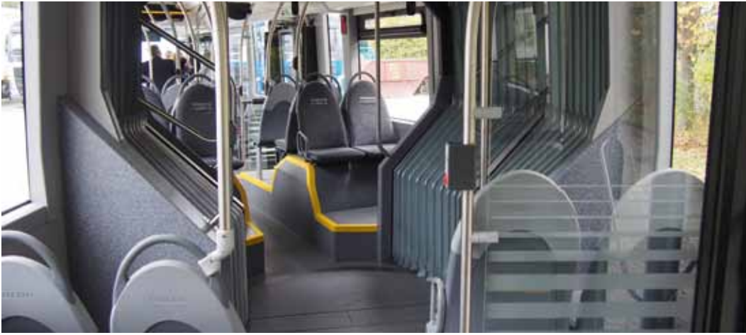
Klares Innenrauml layout ohne Schnickschnack; VDV-konformes Cockpit mit einfacher Bedienung; podestfreie Sitze rechts im Nachläufer
