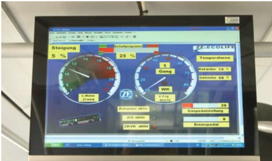
Die Betriebszustände aus dem CAN-Bus werden im Getrieberechner zur passenden Schaltstrategie verarbeitet.
